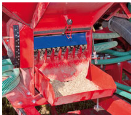
Zum Abdrehen haben wir die Abdeckung geöffnet und die Auffangschale untergestellt. Das Abdrehen geht schnell und einfach.
