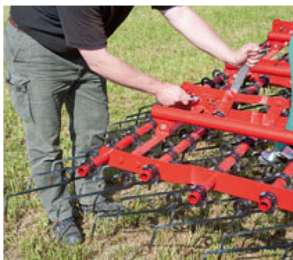
Der Anstellwinkel der Zinken kann über ein Parallelogramm verändert werden. Die Prallteller sitzen am dritten Zinkenträger.
